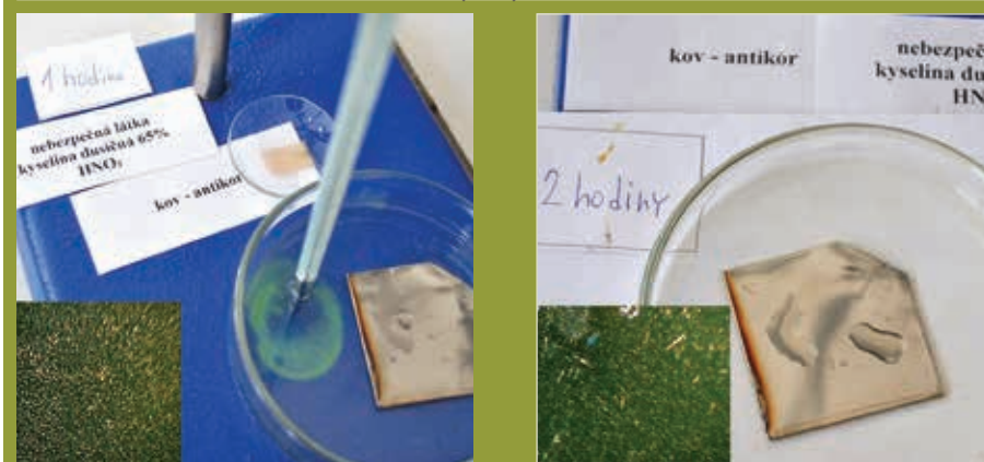
Obrázok 7 Vzorky antikor s \text{HNO}_3 po 60 min. a po 120 min. s mikroskopickými snímkami
