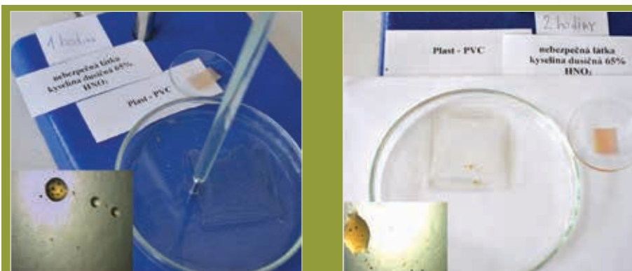
Obrázok 13 Vzorky PVC s \text{HNO}_3 po 60 min. a po 120 min. s mikroskopickými snímkami
