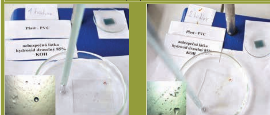
Obrázok 14 Vzorka PVC s KOH po 60 min. a po 120 min. s mikroskopickými snímkami
