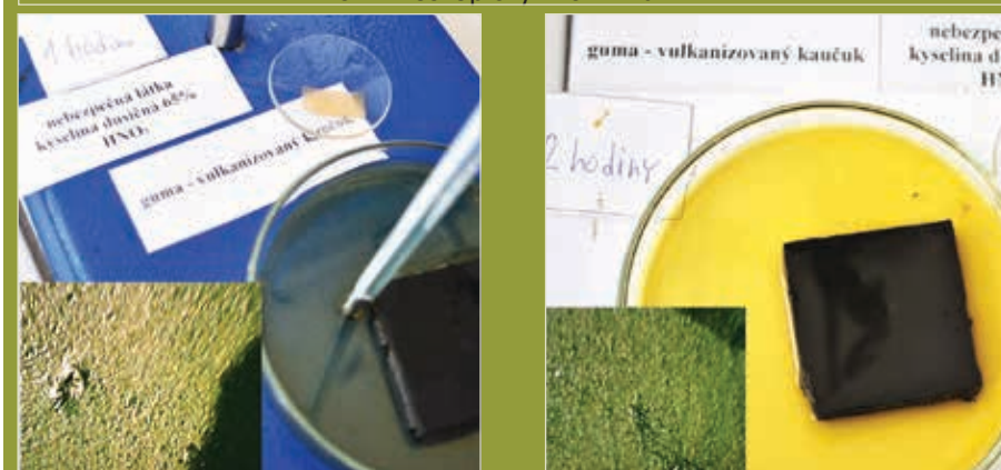
Obrázok 9 Vzorky vulkanizovaného kaučuku s \text{HNO}_3 po 60 min. a po 120 min. s mikroskopickými snímkami
