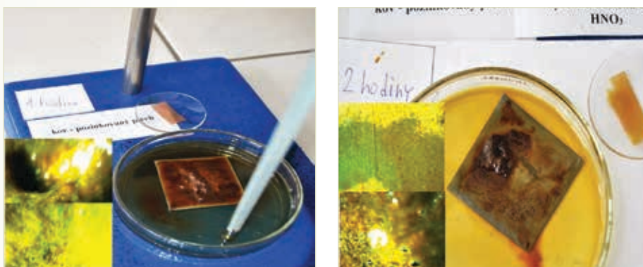
Obrázok 5 Vzorky pozinkovaného plechu s \text{HNO}_3 po 60 min. a po 120 min. s mikroskopickými snímkami
