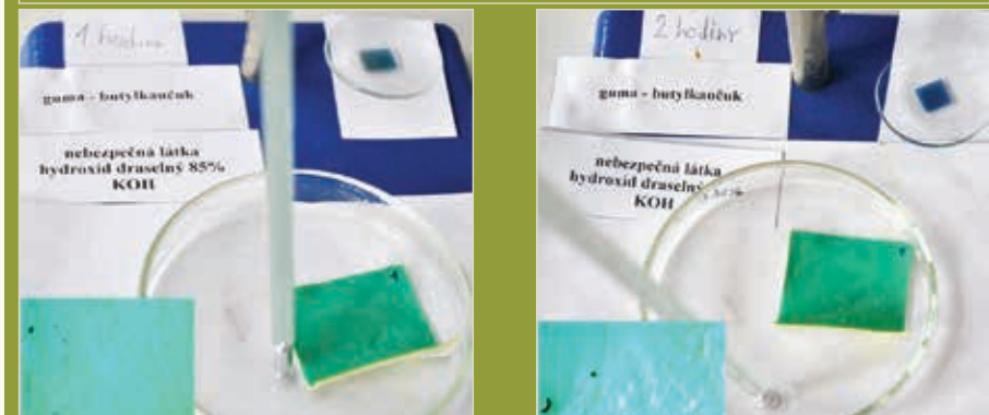
Obrazok 12 Vzorka butylkaučuku s KOH po 60 min. a po 120 min. s mikroskopickými snímkami
