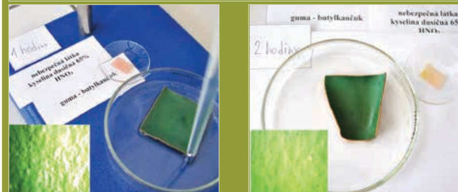
Obrazok 11 Vzorky butylkaučuku s HNO 3 po 60min. a po 120 min. s mikroskopickými snímkami
