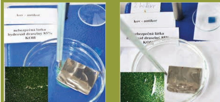
Obrázok 8 Vzorka antikor s \text{KOH} po 15 min. a po 120 min. s mikroskopickými snímkami
