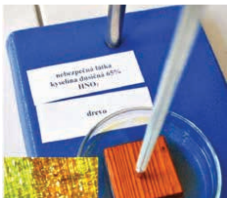
Obrázok 3 Vzorka dreva po 15 minútach a po 120 minútach po aplikácii \text{HNO}_3
