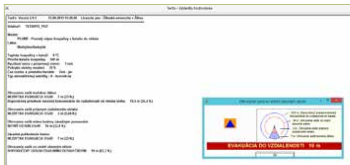
Obrázok 21. Parametre úniku NL a zóna ohrozenia pre IDLH v programe Terex (PLUME)
