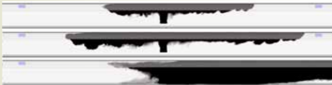
Obr. 3. Rez priestorového rozloženia dymu v tuneli postupne v 54., 58., 80. a 115. sekunde.
