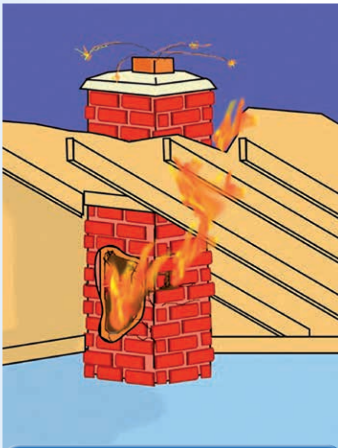
Prenos požiariu na strešnú konštrukciu
