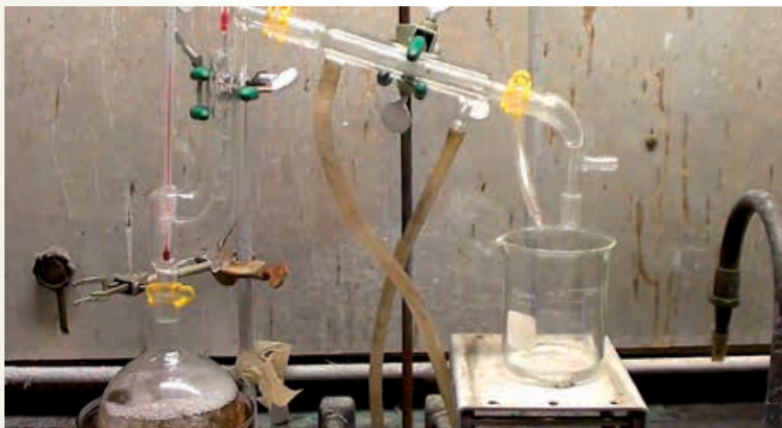
Hydrazín sa pripravuje reakciou vodného amoniaku s roztokom chlórnanových soli. Hydrazín síran vzniká reakciou hydrazínu s kyselinou sírovou.
